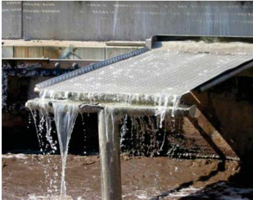
Das Bild links zeigt eine Versuchsanordnung (Dauerversuch) einer Fercher Wärmetauscherplatte zu Messzwecken in einem Abwasserbecken.
