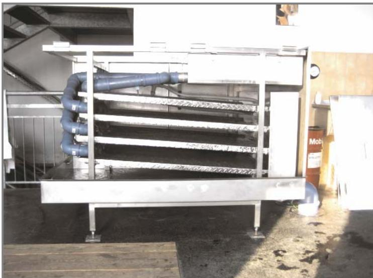
Der **FERCHER FB-4/S** mit abgenommenen Abdeckungen. Am Bild zu sehen die Abwasserverteilerwanne (rechts oben), die Polokal-Abwasserverteilerrohre (blau) und die geneigten Fercher Absorberplatten.
