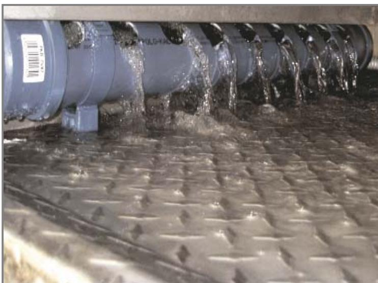
Das Abwasser wird anschließend gleichmäßig auf der jeweiligen Fercher-Absorberplatte verteilt und fließt als dünner Film an der Absorberplatte ab.
