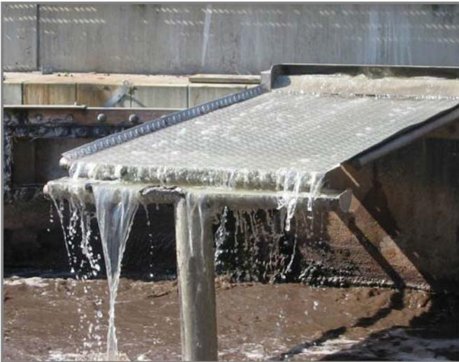
Das Bild links zeigt eine Versuchsanordnung einer Fercher Wärmetauscherplatte zu Messzwecken in einem Abwasserbecken.
